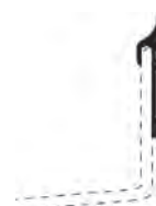
Afdichtingsrubber (Roval 152010) Voor de afdichting van de achterzijde van waterslagen
