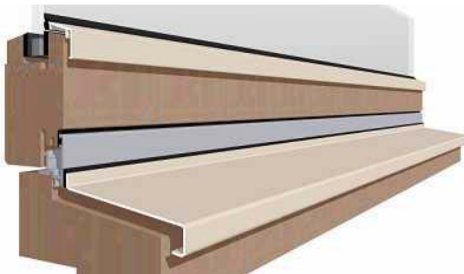
Waterslag uit gezette plaat
